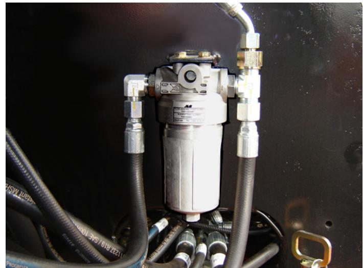
Intervallo: cambiare dopo le prime 50 ore e in seguito ogni 6 mesi o 300 ore.
