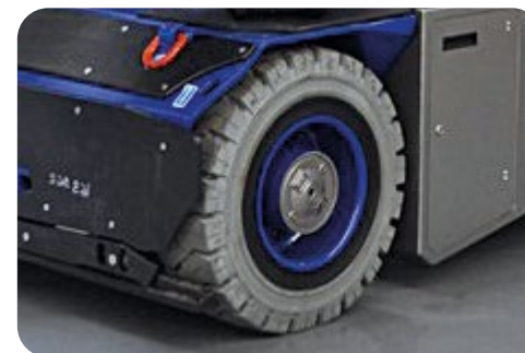
RUOTE ANTITRACCIA Non-marking tires / Roues non marquant Non-Marking-Räder / Ruedas anti-marcas
