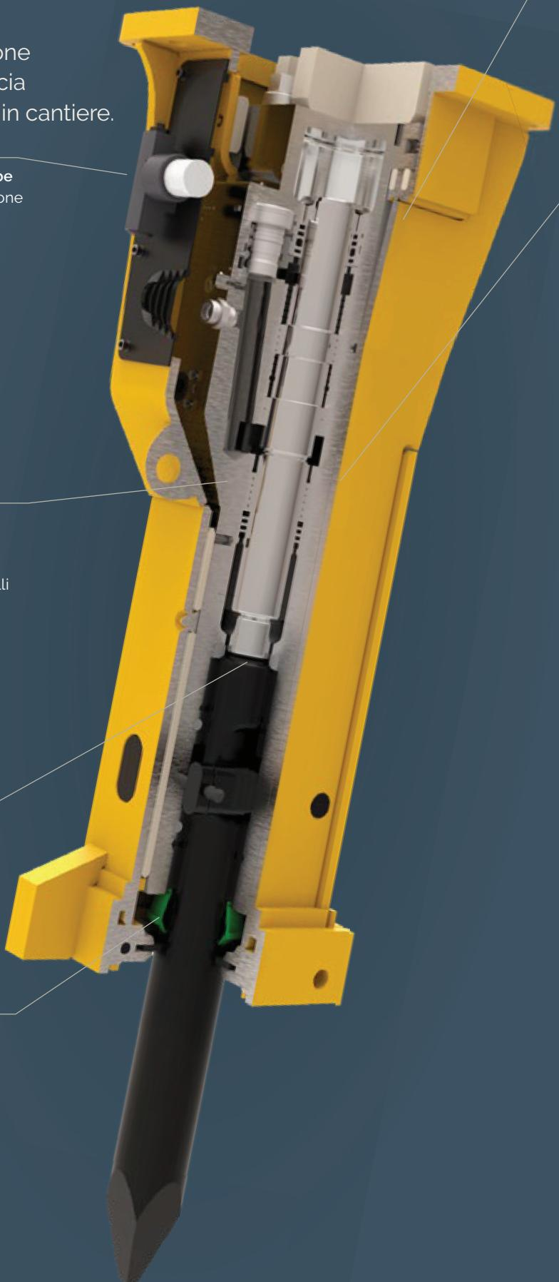
Il sistema automatico di commutazione **AutoControl** regola il rapporto in uscita durante il funzionamento ottimizzando le prestazioni.
